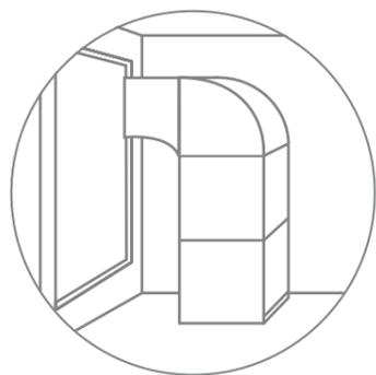
Увеличен статический напор вентилятора наружного блока до 110 Па. Это позволяет устанавливать блоки на технических этажах высотных зданий и с помощью воздуховодов отводить горячий воздух наружу.
