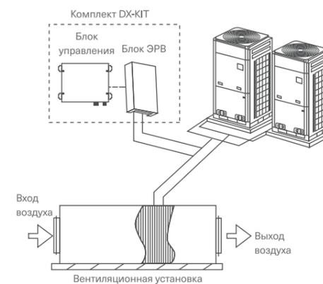
Подключение комплекта к наружным блокам и совместная работа с внутренними блоками VRF-системы
