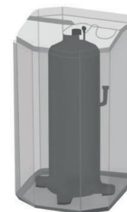
Между компрессором и внешней металлической оболочкой компрессорного отсека установлены усовершенствованные звукопоглощающие и звукоизолирующие материалы. Такое конструктивное решение позволяет значительно снизить уровень шума наружного блока.
