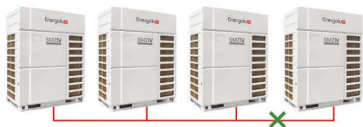
Между наружными блоками одной системы не требуется внешняя маслоуравняющая трубка. Распределение масла между блоками осуществляется автоматически на основании сбора данных, расчета производительности и пороговых значений параметров каждого блока.
