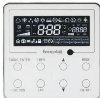
Проводной пульт SWC79MZ2 может быть использован для управления от 1 до 16 внутренних блоков. Возможно одновременное подключение 2 пультов к одному внутреннему блоку. Пульт позволяет определять температуру окружающей среды и принимать сигнал инфракрасного пульта дистанционного управления. Возможно подключение модуля для гостиничной ключ-карты. Модуль и ключ-карта гостя приобретается отдельно у стороннего производителя.
