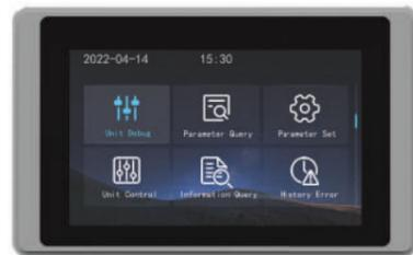
Предназначен для настройки параметров, мониторинга, детальной диагностики работы VRF-систем. Отслеживание неисправностей и историю их возникновения.
