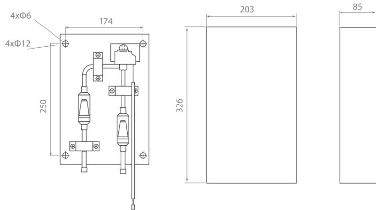
Габаритные и установочные размеры блока TPB для модели SDX 560 G2
