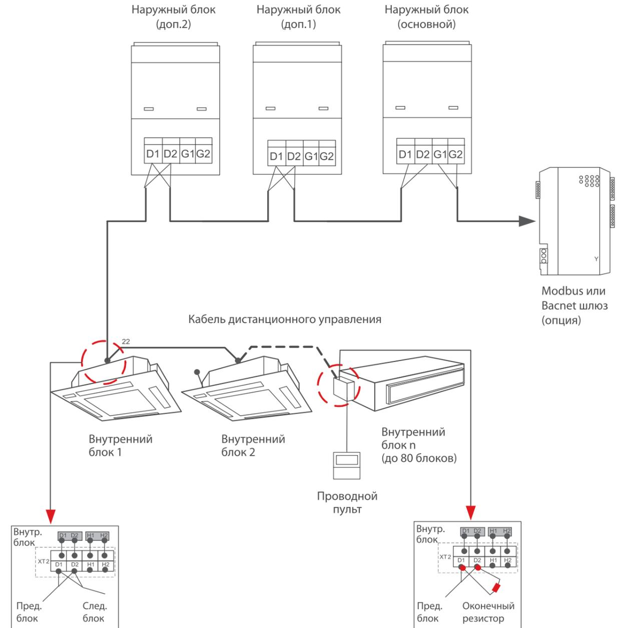
Внутренние и наружные блоки подключаются к разным источникам электропитания. Все внутренние блоки подключаются к одному источнику питания. В силовой цепи необходимо предусмотреть прерыватель замыкания на землю (УЗО) и автоматический выключатель защиты от токовых перегрузок.
