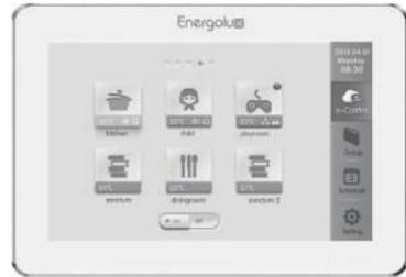
Центральный пульт управления с сенсорным дисплеем SCC54G1 предназначен для центрального управления с возможностью контроля до 16 систем и 32 внутренних блоков.
