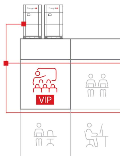
При отключении от основного источника питания и временном использовании резервной линии питания от дизель-генератора, наружный блок сигнализирует об этом в систему. С этого момента в работе остаются только внутренние блоки с установленным VIP-статусом.
