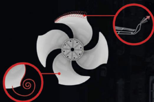
Загнутые вперед S-образные лопасти имеют увеличенную рабочую площадь, что существенно повышает расход воздуха. При разработке формы внешнего края лопасти учитывался опыт проектирования крыла самолета, что позволило эффективно подавить вихревые потоки, создаваемые перепадом давления на краю лопасти, и снизить уровень шума.
