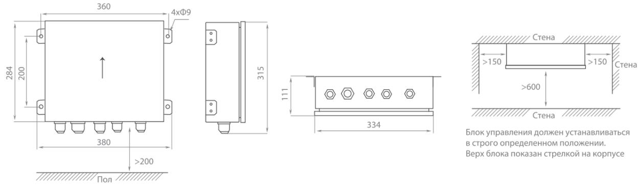
Габаритные и установочные размеры блоков TPB для моделей SDX 36 G2, SDX 71 G2, SDX 140 G2, SDX 280 G2
