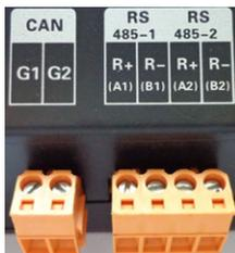
**CAN интерфейс:** подключается к системе кондиционирования воздуха при помощи витой пары, обеспечивая связь между шлюзом Modbus и системой кондиционирования воздуха.
