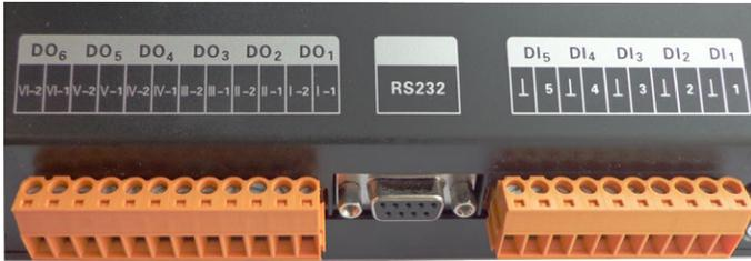
Внешний вид терминала сетевого шлюза (цифровые входы и выходы).
