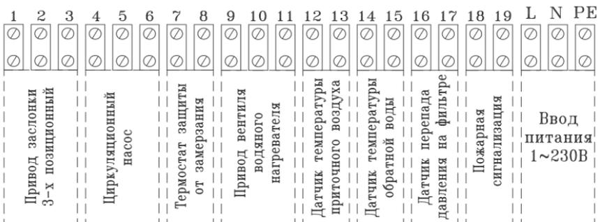
Схема для установок с электрическим нагревателем 1 фазным.
