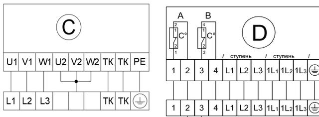
Число ступеней на конкретной клеммной колодке определяется числом ступеней мощности электронагревателя установки.
