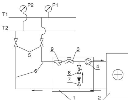
T1 и T2 — подающий и обратный трубопроводы сети теплоснабжения, 1 — узел обвязки; 2 — calorifier водяной; 3 — регулирующий клапан; 4 — циркуляционный насос; 5 — запорные вентили; 6 — подающий и обратный трубопроводы от сети теплоснабжения к calorifierу; 7 — обратный клапан; 8 — баланси- ровочный вентиль; 9 — водяной фильтр.
