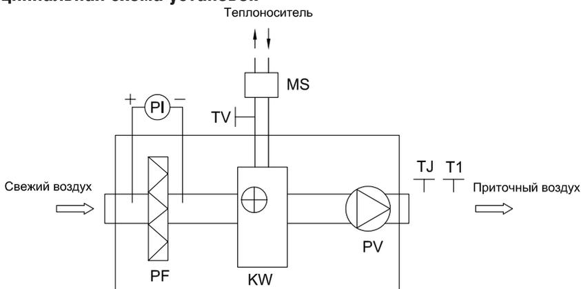
PV — вентилятор приточного воздуха;
