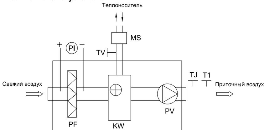
PV — вентилятор приточного воздуха;
