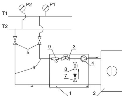
T1 и T2 — подающий и обратный трубопроводы сети теплоснабжения, 1 — узел обвязки; 2 — calorifer водяной; 3 — регулирующий клапан; 4 — циркуляционный насос; 5 — запорные вентили; 6 — подающий и обратный трубопроводы от сети теплоснабжения к caloriferу; 7 — обратный клапан; 8 — балансировочный вентиль; 9 — водяной фильтр.
