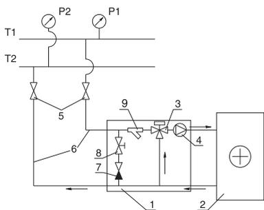
*Возможная схема обвязки с двухходовым регулирующим клапаном*
