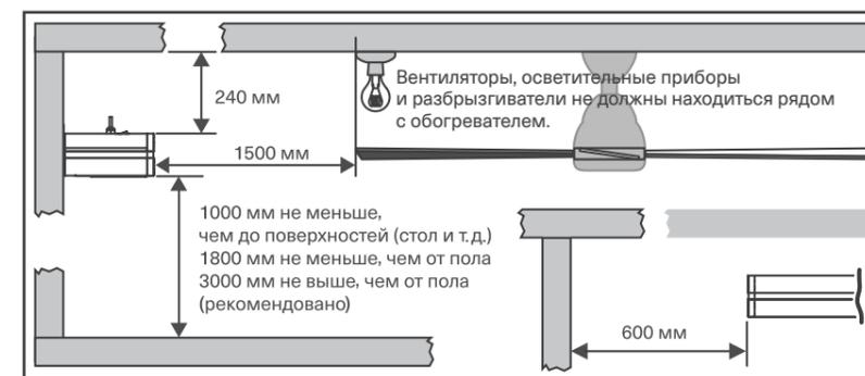
**Внимание:** Устройство должно эксплуатироваться только в горизонтальном положении с максимальным уклоном  $\pm 5^\circ\text{C}$ . Никогда не устанавливайте устройство на легковоспламеняющуюся поверхность (пластик, нейлон, картон и т.д.).
