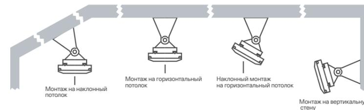
Оптимальное монтажное положение – непосредственно над обогреваемой зоной с продольной ориентацией и направлением вертикально вниз. Если это невозможно, обогреватель(и) можно устанавливать на стене под углом вниз. В этом случае высота установки должна быть в пределах от 2,1 до 2,5 м.
