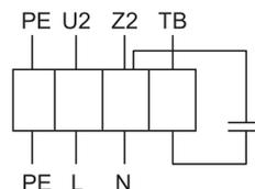
Схема электрических соединений SDC XL (1 ~ 230 В)
